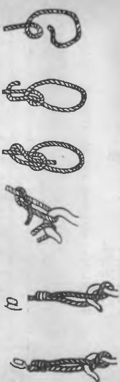
Рис. 78. Операции изготовления морского узла
