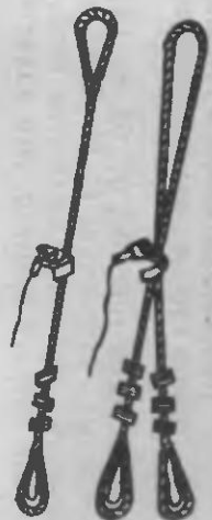
Рис. 64 Полуавтоматический строп-удавка. 1 — серыга, 2 — замок, 3 — запорный штырь, 4 — корпус, 5 — тросик
