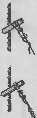
Рис. 77. Закрепление каната зажимами
